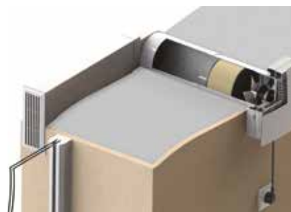
Montaż kątowy z zastosowaniem kanału wentylacyjnego i kolanka 90°
